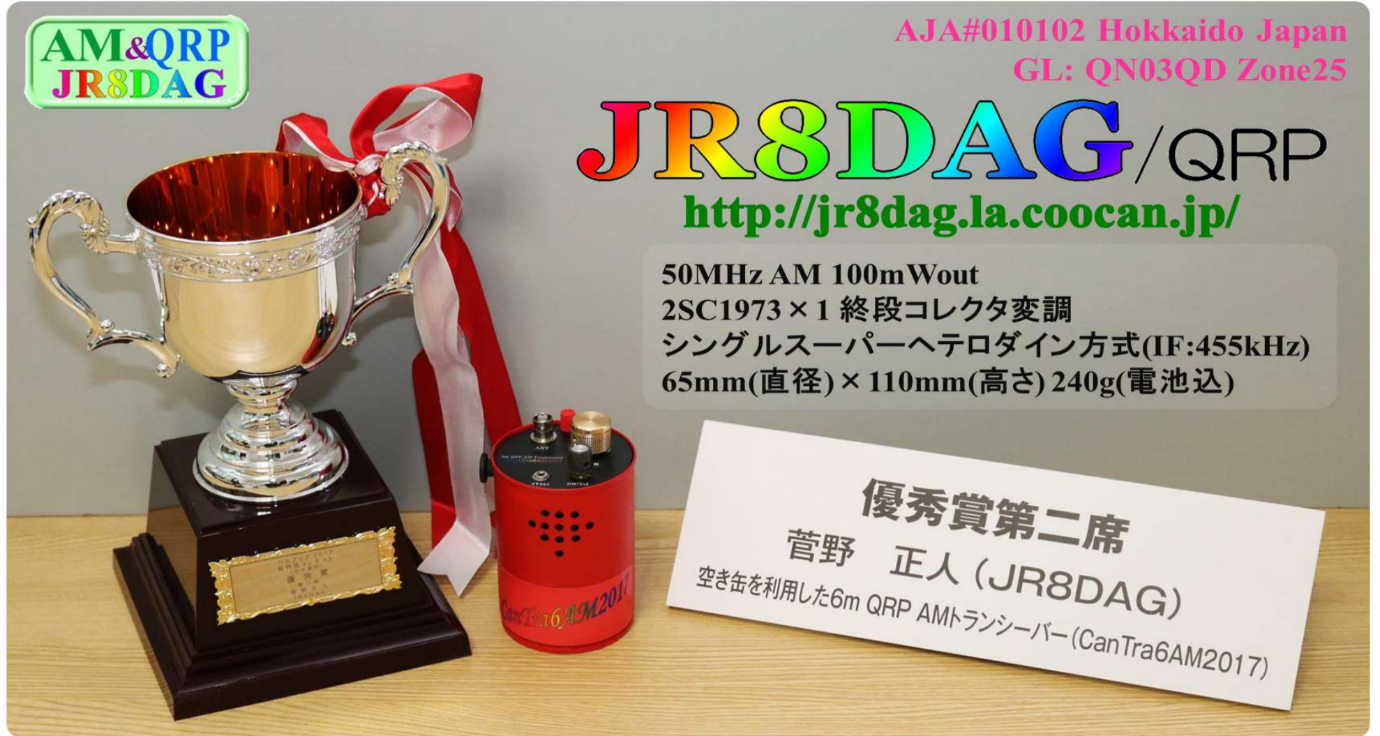
空き缶を利用した6m QRP AMトランシーバー(CanTra6AM2017) ハムフェア2017自作品コンテスト自由部門優秀賞第二席
