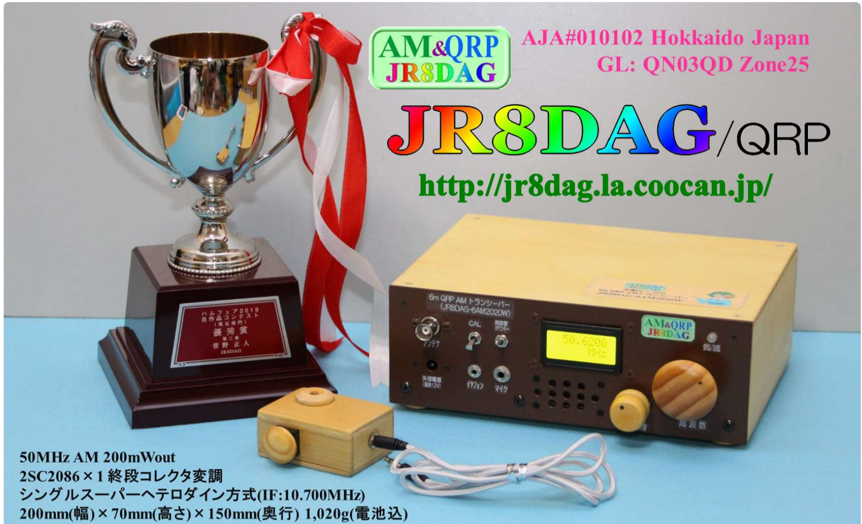
木製ケースの6m QRP AM トランシーバー(JR8DAG-6AM2020W) ハムフェア2019自作品コンテスト規定部門優秀賞第3席
