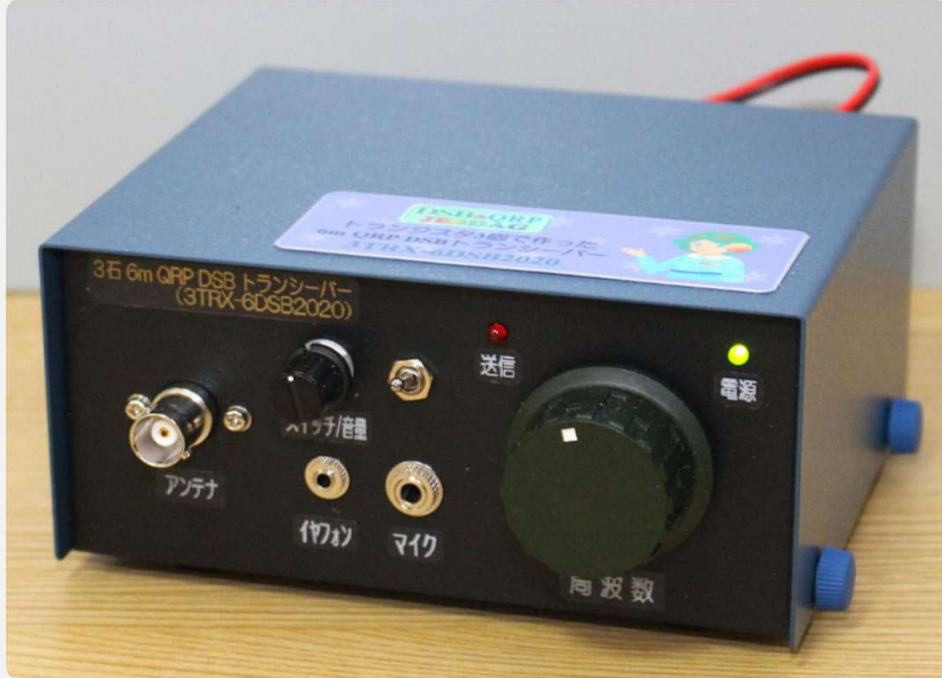
トランジスタを3個で作った6m QRP DSB トランシーバー(3TRX-6DSB2020)
